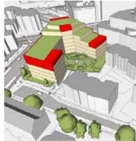
Aanpassing hoofdmassa - verwijderen rode onderdelen
